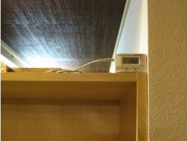
室内の温度湿度を記録する温度計
