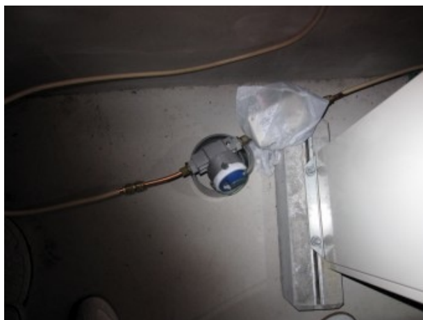
外気温を記録する防水型温度計
