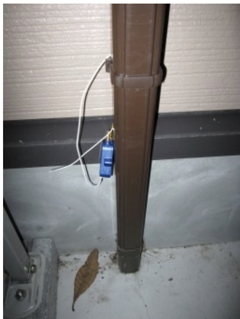
外気温を記録する防水型温度計
